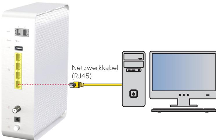
4. Schliessen Sie Ihren PC oder Laptop mit Hilfe eines Netzwerkkabels (RJ45) an eine der gelben Buchsen an.
